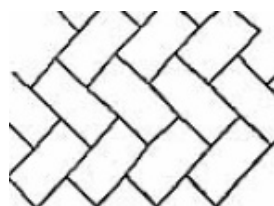
間知石等の谷積み
